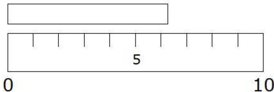
L'objet  $x$  que l'on mesure se trouve entre la 6<sup>ème</sup> et la 7<sup>ème</sup> graduation, on dira qu'il mesure  $6 \pm 0,5$  cm ou bien,  $5,5 \leq x \leq 6,5$ .
