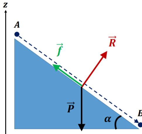
On considère un objet de masse  $m = 50 \text{ kg}$  glissant avec frottements sur un pan incliné d'angle  $\alpha = 30^\circ$  par rapport à l'horizontale. Il part sans vitesse initiale du point A situé à une hauteur  $h = z_A - z_B = 10 \text{ m}$ . On prendra  $g = 10 \text{ N.kg}^{-1}$
