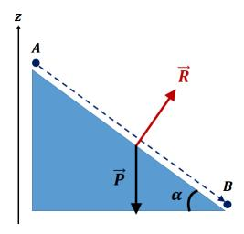
On considère un objet de masse m=50 kg glissant sans frottements sur un pan incliné d'angle  $\alpha=30^\circ$  par rapport à l'horizontale. Il part sans vitesse initiale du point A situé à une hauteur  $h=z_A-z_B=10$  m. On prendra g=10 N.kg<sup>-1</sup>
