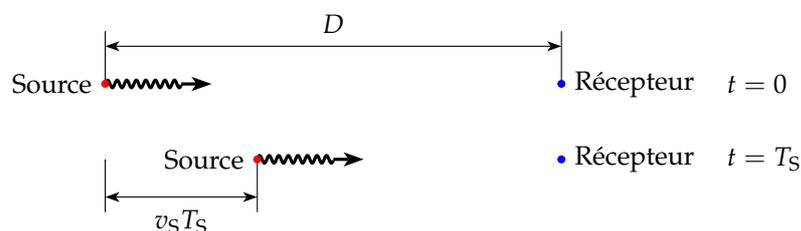
Par rapport au récepteur, fixe par rapport au milieu de propagation, la distance  $d_1$  entre deux bips est donc :  $d_1 = cT_S - v_S T_S$
