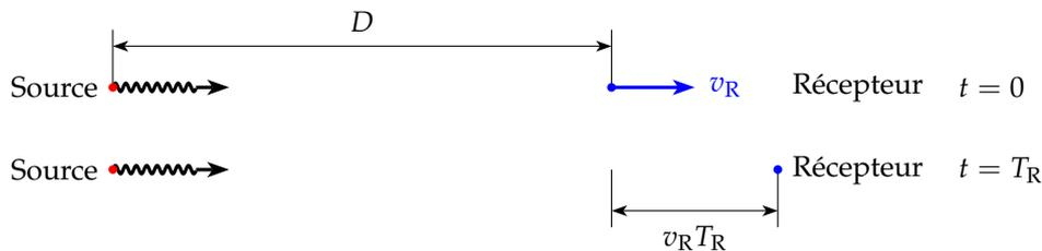
Par rapport au récepteur, la source s'éloigne à la vitesse  $v_R$ , la distance  $d_1$  entre la réception de deux bips est donc :  $d_1 = cT_S + v_R T_R$ .
