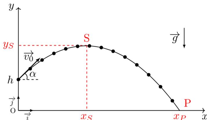
Figure 12.2 – Schéma d'une chute libre en deux dimensions, avec la trajectoire  $y(x)$  représentée.
