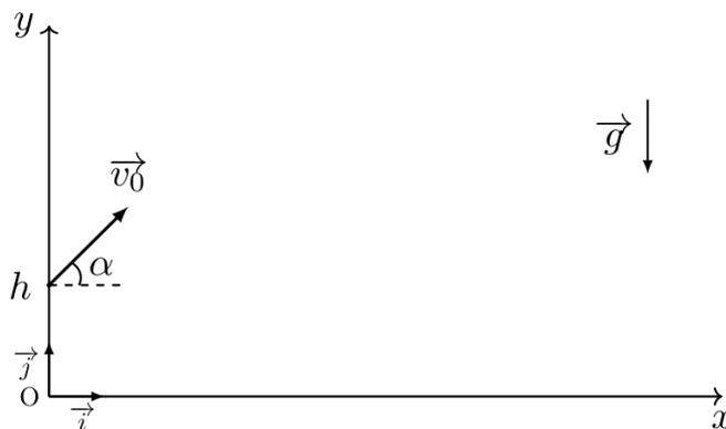
Figure 12.1 – Schéma d'une chute libre en deux dimensions
