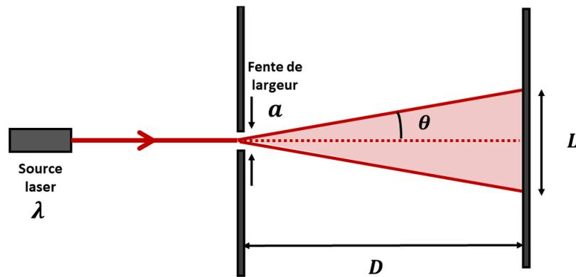
**Figure 17.3** – Montage expérimental permettant d'illustrer la diffraction d'un laser par une fente de largeur  $a$ .
