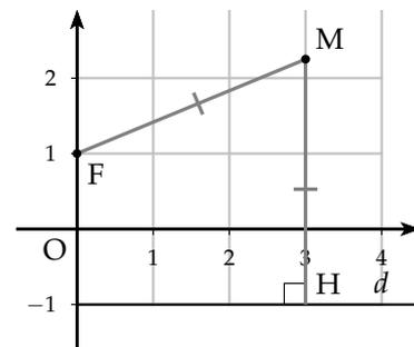
M est donc sur la médiatrice de [FH]. Pour tracer un point M, on prend un point quelconque H sur la droite  $d$ . On trace ensuite la médiatrice de [FH]. M est alors l'intersection de cette médiatrice avec la perpendiculaire à  $d$  en H. On obtient alors l'ensemble des points M lorsque H parcourt  $d$  :
