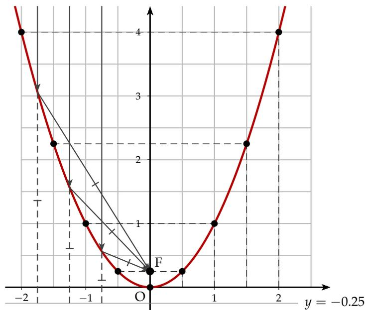
**Propriété :** Cette parabole possède un foyer  $F(0; 0,25)$ . Tous les points de la parabole sont équidistants de la droite d'équation  $y = -0,25$  et du foyer  $F$ .
