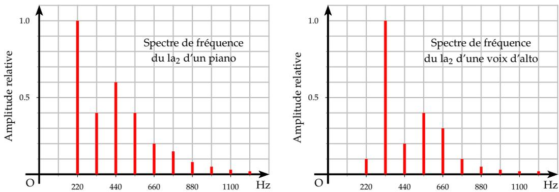
On obtient les profils suivants des ondes produites par le piano et par une voix d’alto :
